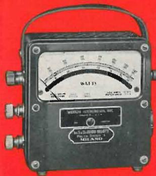
Fig. 3 - Wattmetro portatile
