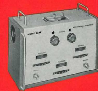
Fig. 8 - Ponte per misure d'ammiettanza VHF
