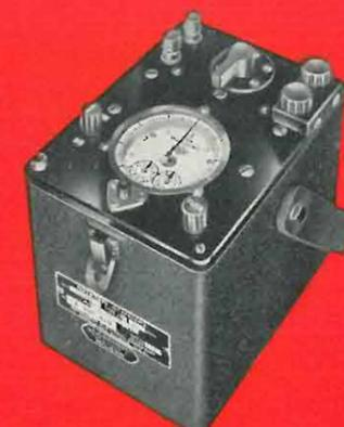
Fig. 4 - Contatore campione portatile
